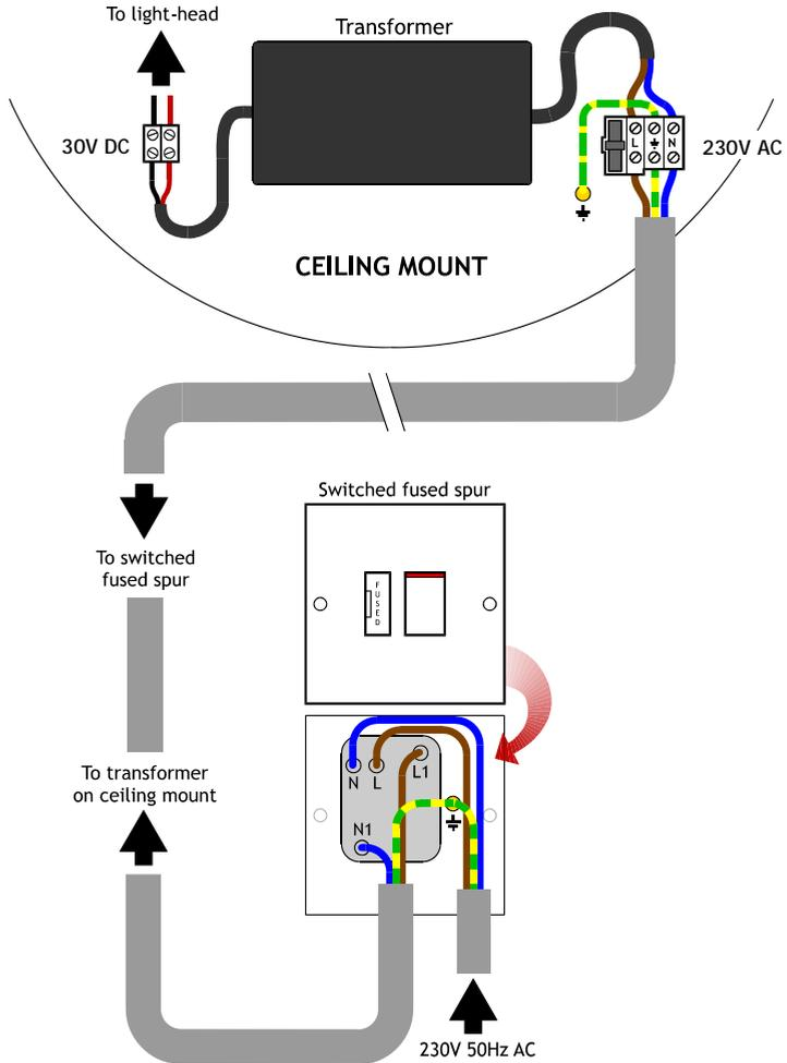
*SL180LEDC wiring diagram*
